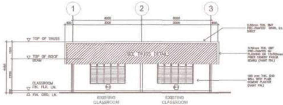
2 LONGITUDINAL SECTION A-3 SCALE: 1:80M
